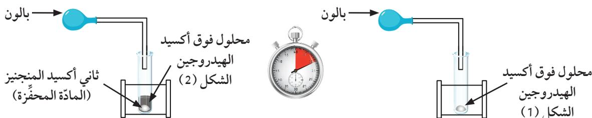
4. ضَعُ محلّول فوق أكسيد الهيدروجين في أنبوبة الاختبار، الشكل (1)، وضَعُ قليلاً من ثاني أكسيد المنجنيز (المادّة المحفّزة)، ثمَّ أضف إليها محلّول فوق أكسيد الهيدروجين في أنبوبة الاختبار، الشكل (2). قارن بين الزمن المستغرق لحدوث التفاعل الكيميائي فيها.
